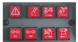
操作プロセスを表示パネルで確認しながら、張出せます。
